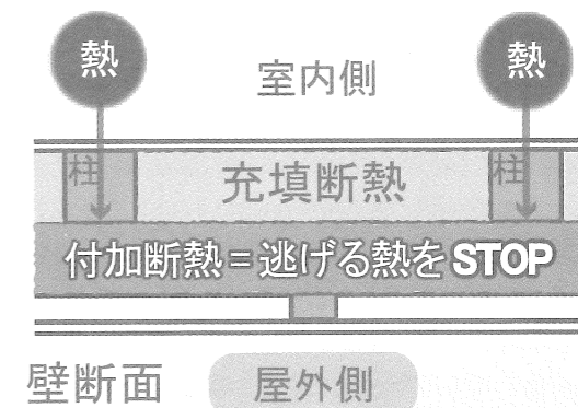
[fig.3] ヒートブリッジと付加断熱
