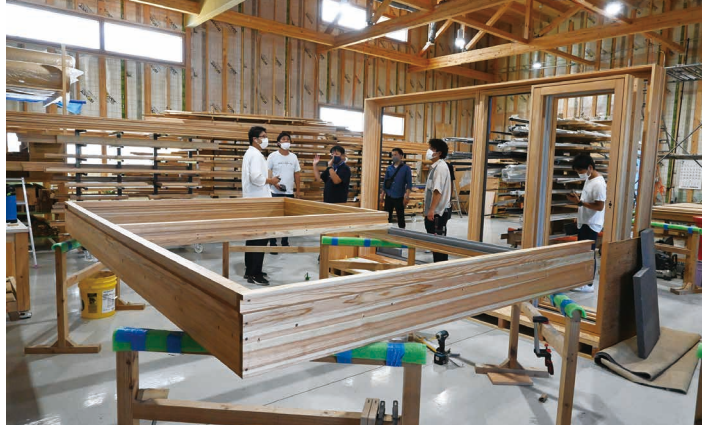
「佐藤の窓」は、Uw値0.7W/㎡Kを切る断熱性能と日射取得率59%（トリプルガラスECLAZ）という性能の高さ、屋外側の木枠部分をアルミでカバーするアルミクラッドによる耐久性、8.6cm以下という細いフレームのデザイン性、フリーサイズ（縦・横2340cm×3300cm以内）で製造できる柔軟性などが特長だ。フレームは主に九州地方のスギ材（独自の集成加工）を使い、ガラスは提携のガラス工場がECLAZを在庫して国内で製作している
