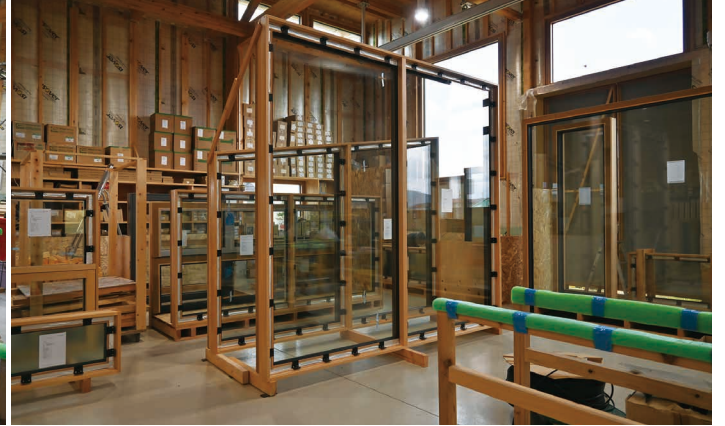
「佐藤の窓」は、Uw値0.7W/㎡Kを切る断熱性能と日射取得率59%（トリプルガラスECLAZ）という性能の高さ、屋外側の木枠部分をアルミでカバーするアルミクラッドによる耐久性、8.6cm以下という細いフレームのデザイン性、フリーサイズ（縦・横2340cm×3300cm以内）で製造できる柔軟性などが特長だ。フレームは主に九州地方のスギ材（独自の集成加工）を使い、ガラスは提携のガラス工場がECLAZを在庫して国内で製作している
